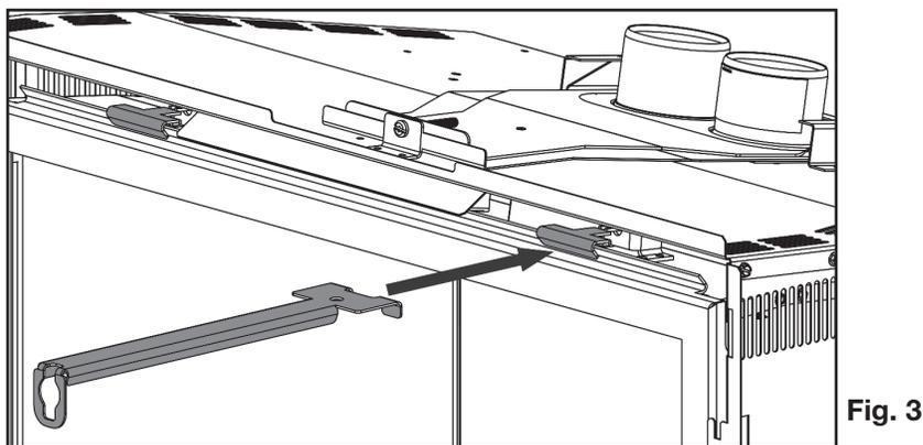
3. Inversez ces étapes pour réinstaller la barrière de protection et la porte. Assurez-vous que la barrière de protection est correctement installée.
