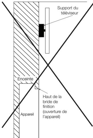
Installation partiellement enchâssées avec un manteau
